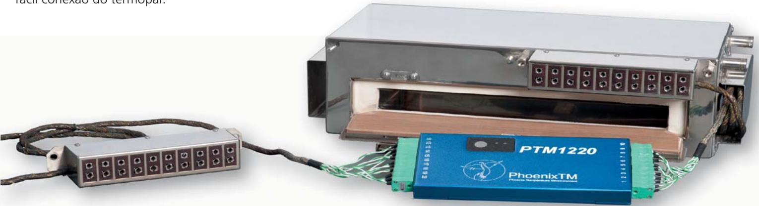
Barreira Térmica evaporativa em aço inox com isolamento em microporos e saída dupla de termopares para coletores de dados com 20 canais.
