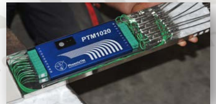
Uma bandeja integrada, com presilhas para termopares, fornece rápida e fácil instalação e remoção do coletor de dados.
