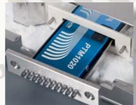
Acessórios de proteção contra água em aço inoxidável proporcionam alívio de estresse para os termopares.
