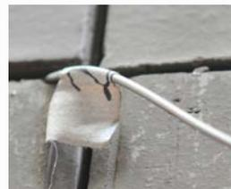
Termopares tipo K e N em 1.5, 2 ou 3 mm de diâmetro.
